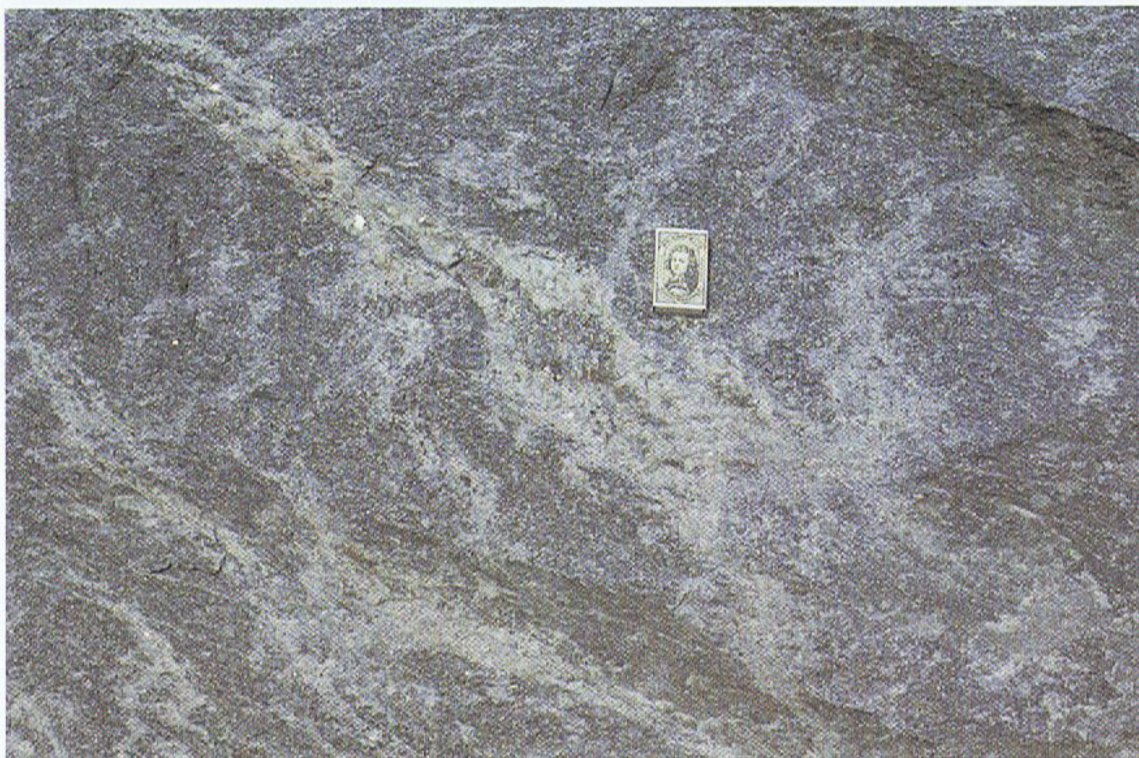
Figur 11. Paradisbakke migmatit med ældre (foldede) og yngre (gennemsættende) lyse slirer. Bertelegård Stenbrud.
