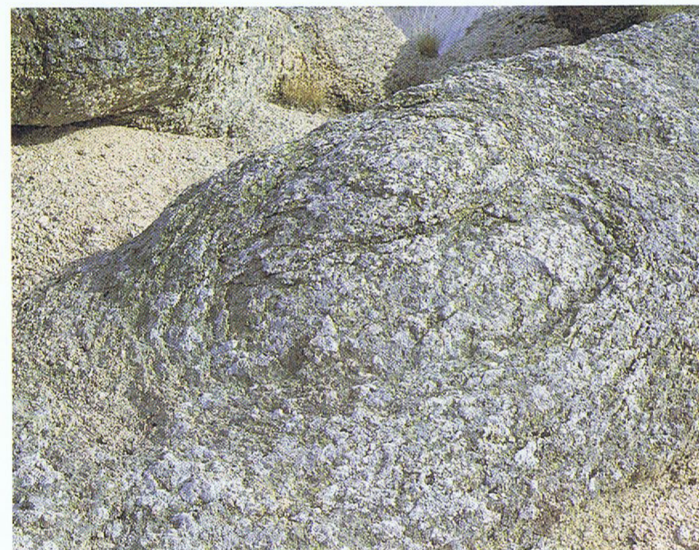
Figur 21. Forvittringsbetinget kugleafskalning i Svaneke granit.
